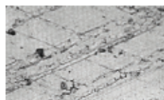
Vytrhaný a podřený povrch - nepřijatelný stav
