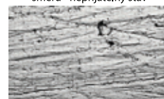
Vytrhané hrany brusného profilu - nepřijatelný stav
