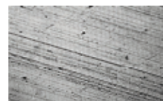
Stopy po obrábění pouze v jednom směru - nepřijatelný stav
