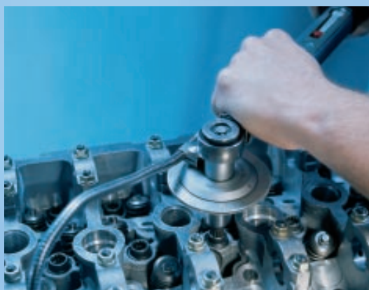
Utahování šroubů hlavy válců s využitím kotouče pro úhel rotace
