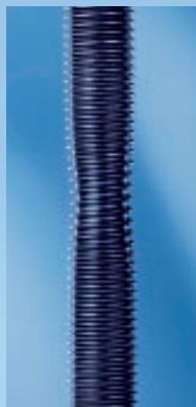
Plasticky prodloužený a zúžený šroub hlavy válců
